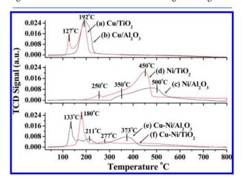
Figure 4.  $H_2$ -TPR spectra for (a)  $Cu/TiO_2$ , (b)  $Cu/Al_2O_3$ , (c)  $Ni/TiO_2$ , (d)  $Ni/Al_2O_3$ , (e)  $Cu-Ni/Al_2O_3$ , and (f)  $Cu-Ni/TiO_2$ .
